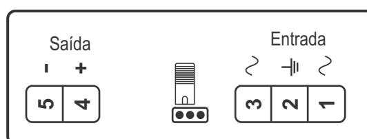
**Atenção:** Deve-se configurar a tensão de entrada através do jumper J1.
